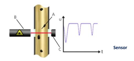
激光光束通过测量单元到对面的光电二极管。如果有颗粒穿过激光光束,光电二极管测量到的光强度会降低。 颗粒越大,光强度降低越多。
